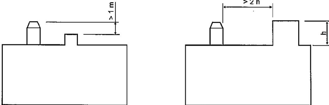
4. Si en los planos de cubierta existieran huecos, será de aplicación lo establecido en la norma UNE relativa al remate de chimenea.
